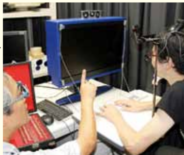
〔眼球運動測定装置〕 眼の動きを計測することで、実験参加者がどこを見ているかが分かる。
